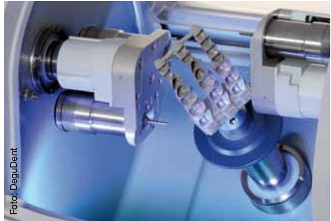
*In der Nassschleifmaschine werden Kronen und Brücken hochpräzise aus einem Crypton-Materialblock herausgeschliffen.*
